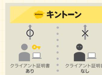
クライアント証明書によって接続端末を認証できます。IPアドレス制限と組み合わせることで、より安全に社外からのアクセスを行えます。
